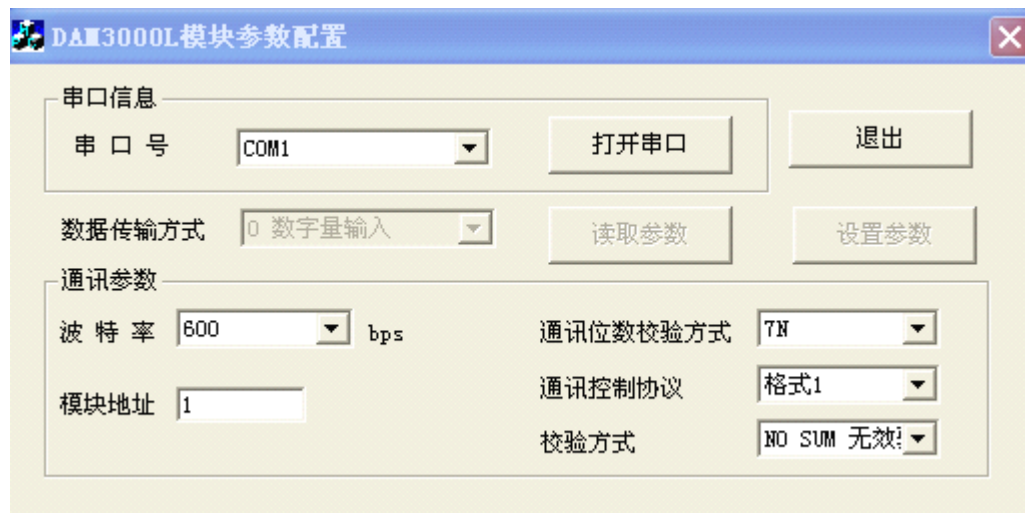
（图 9）DAM-3000L 模块参数配置界面
