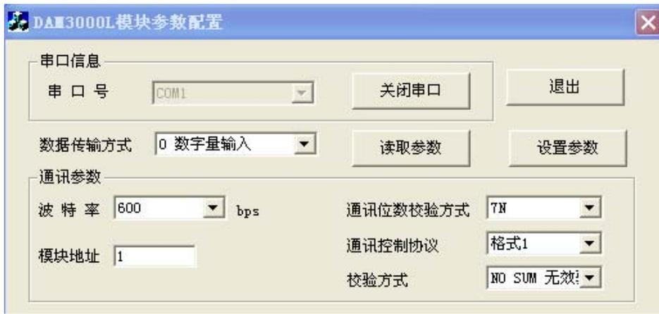
(图 10) DAM-3000L 模块参数配置界面
