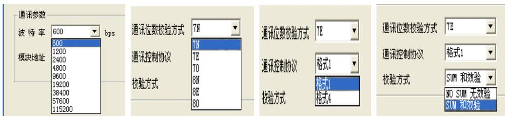
(图 12) DAM-3000L 模块参数配置界面
