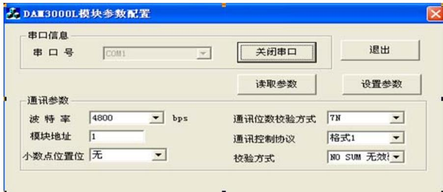
(图 5) DAM-3000L 模块参数配置界面
