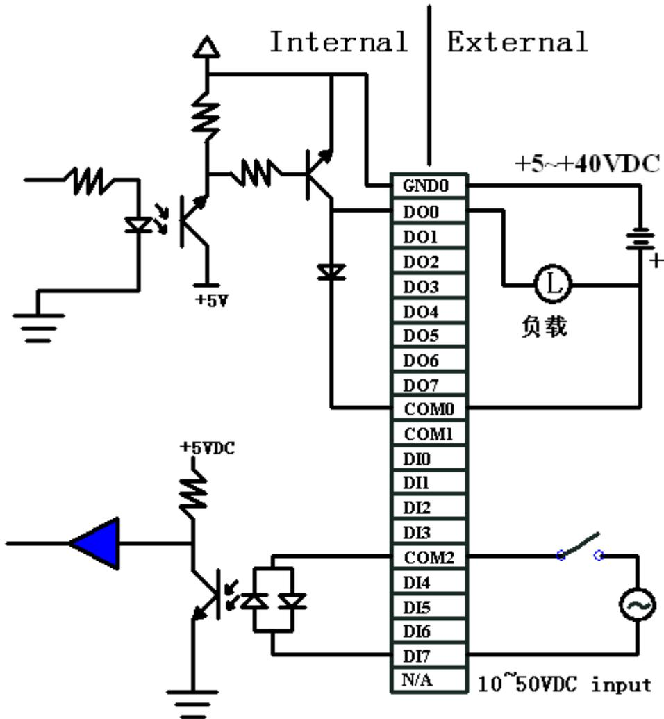
外部接线（上端为输出端口接线，负载电流最大 200mA，下端为输入端口接线）
