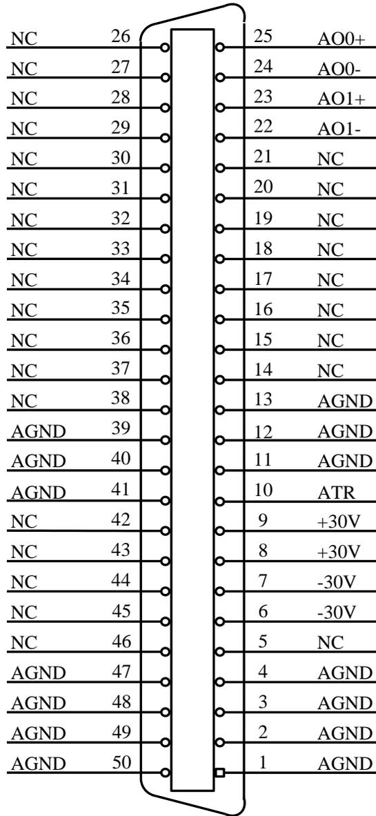
关于 50 芯 SCSI 型插头 CN1 的管脚定义（表格方式）
